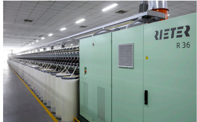
Produktivität und Flexibilität zeichnen die neue Rotorspinmaschine R 36 aus. Zudem senkt die R 36 die Energiekosten um bis zu 10%.
