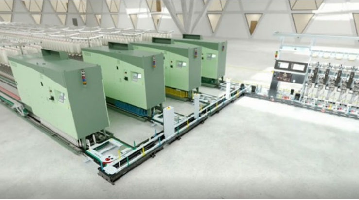
Multilink sistemiyle bobin makinasına bağlantı
