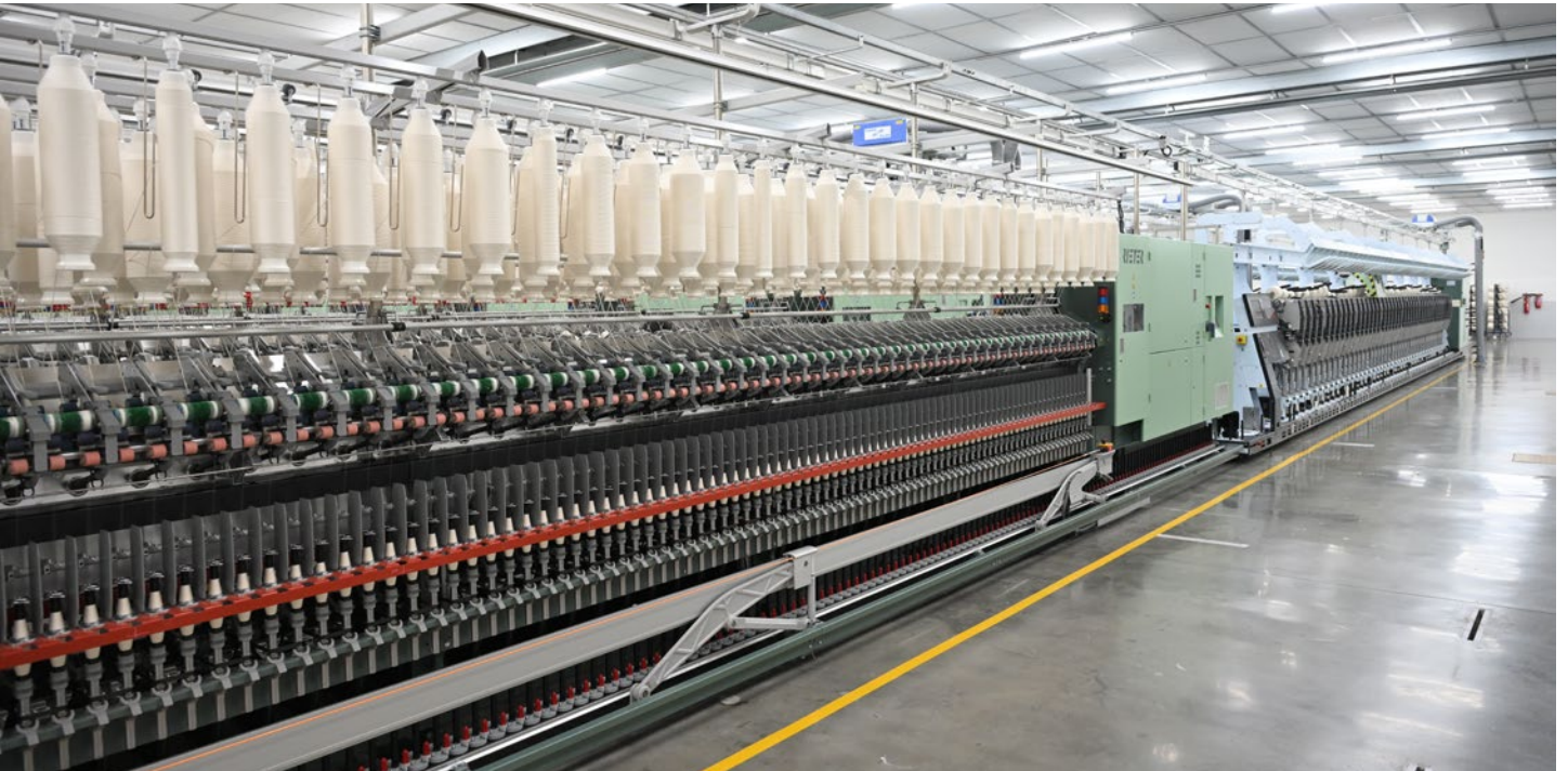
WILDload Sistemi: Masuralar sırayla birer birer alınır ve sonra hizalanarak ROBOLoad masura yükleyiciye beslenir.
