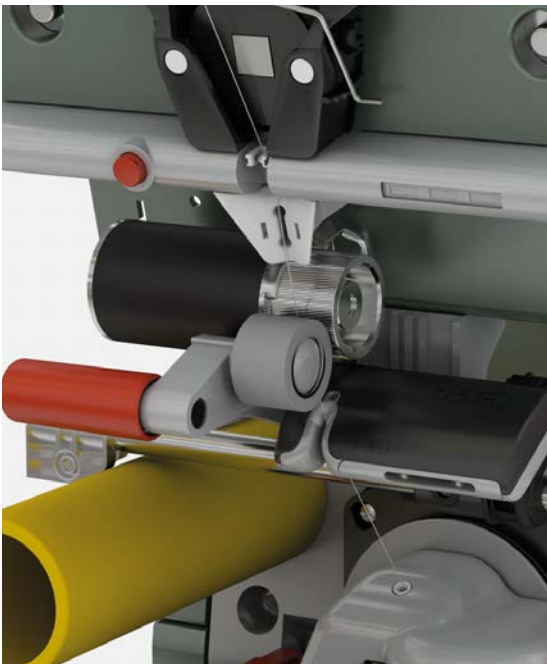
Подача с помощью одного привода AMIspin-Pro (выше) или выпускного вала AMIspin (справа)
