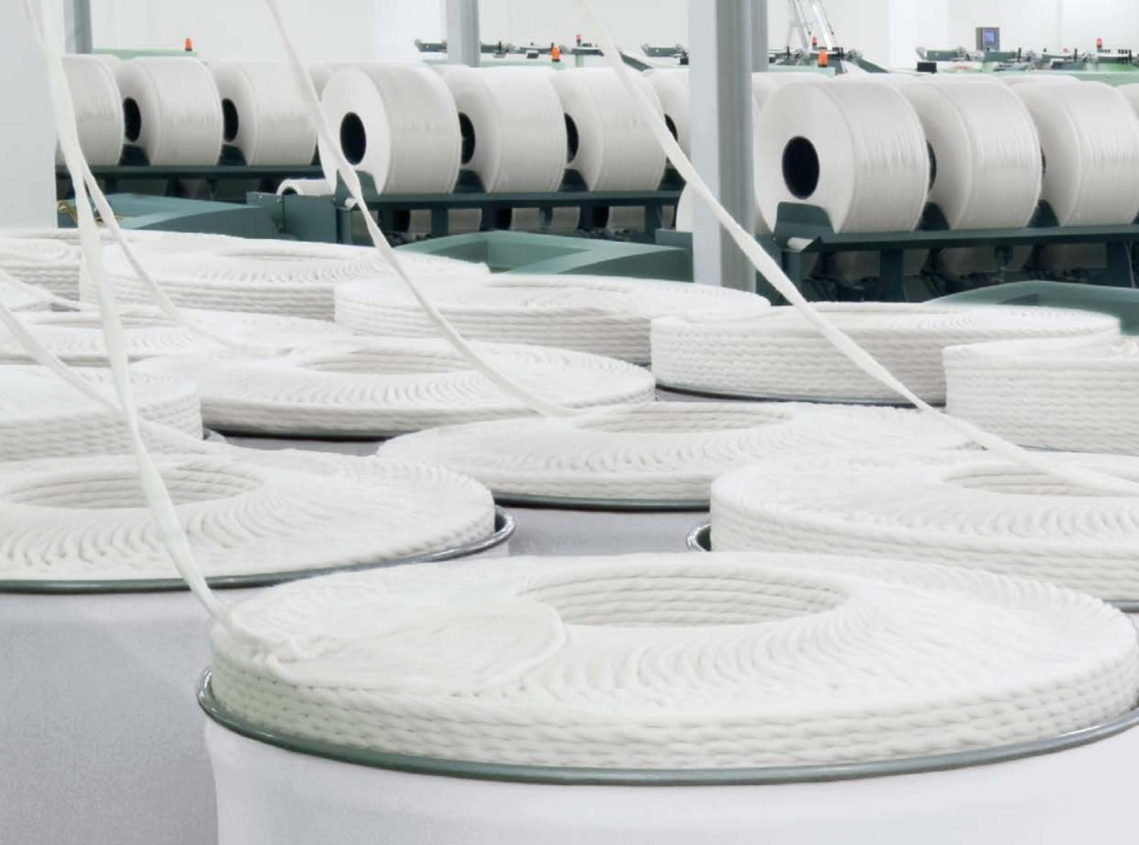
Die Kombination einer hohen Wickelumschlingung und optimaler Druckverteilung garantieren einen homogenen Wickelaufbau, welcher sich durch eine hohe Wattengleichmässigkeit und eine tiefere Haarigkeit auszeichnet.
