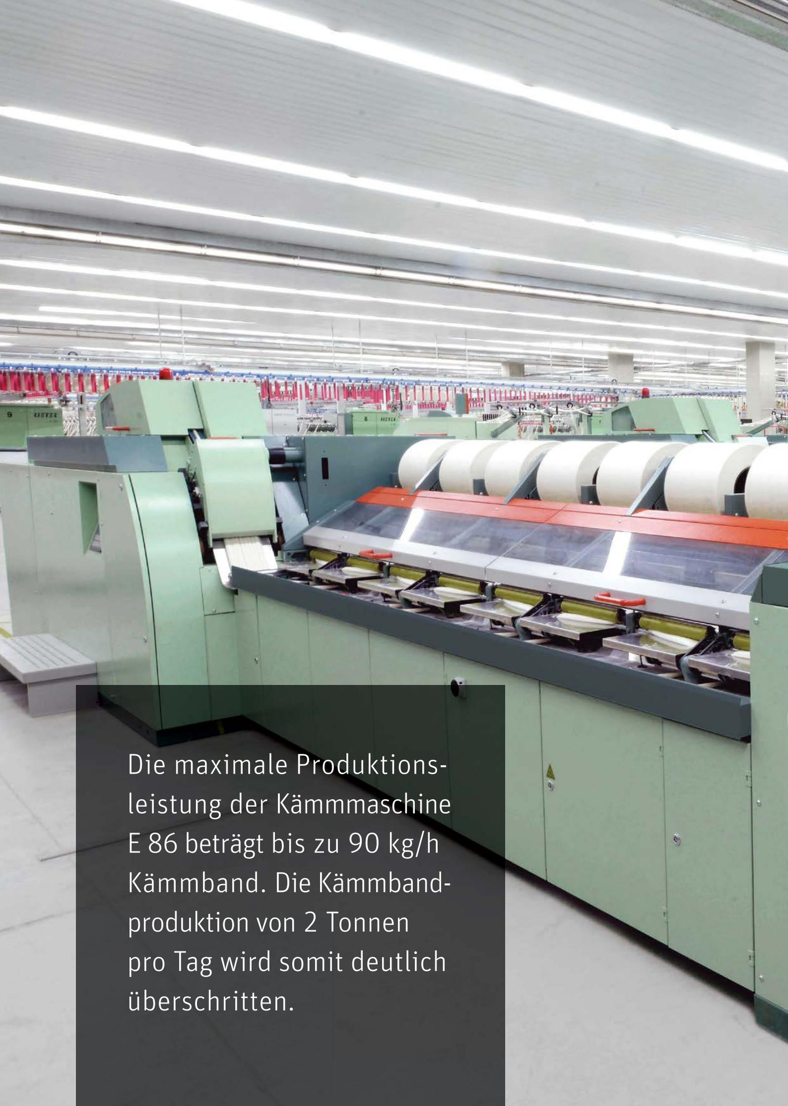
Die maximale Produktionsleistung der Kämmmaschine E 86 beträgt bis zu 90 kg/h Kämmband. Die Kämmbandproduktion von 2 Tonnen pro Tag wird somit deutlich überschritten.
