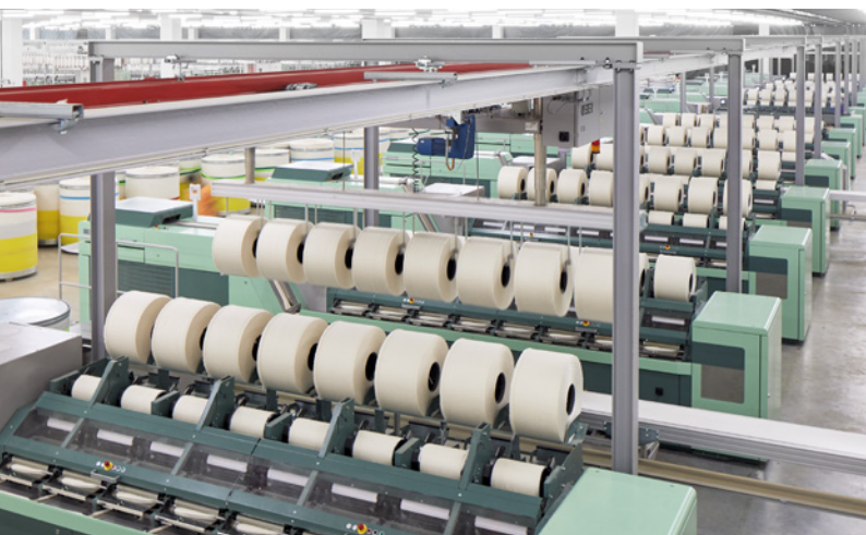
Пример расположения транспортной системы SERVOlap E 26
