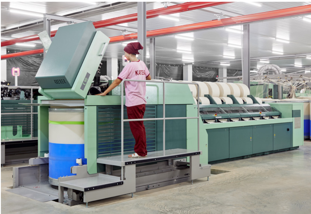
Tecnología integrada de manuar de Rieter
