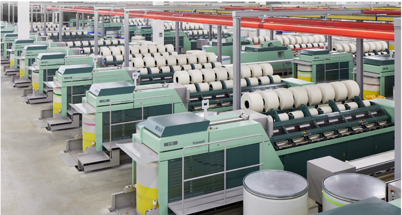
El nuevo diseño de la máquina permite una colocación de la máquina un 11% más cercana
