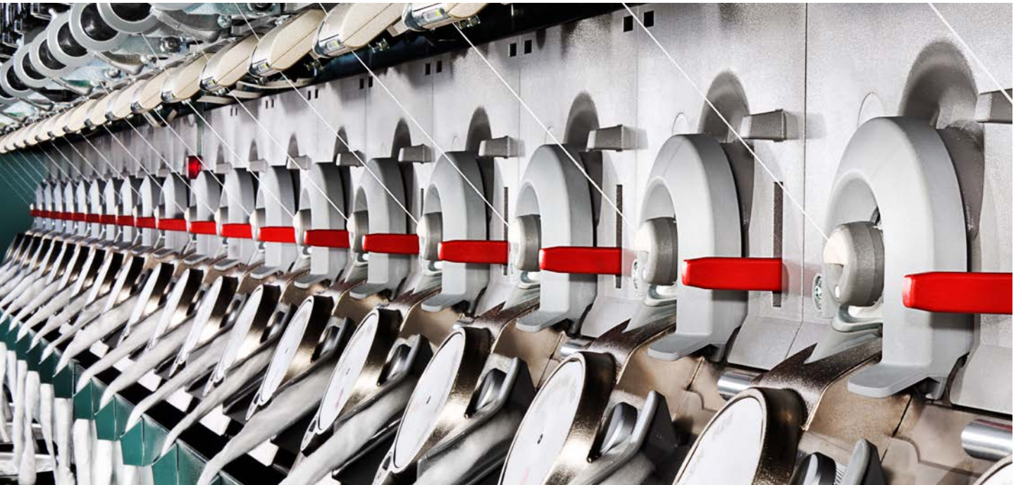
Imagen 1 La R 66 con aspiración en ambas partes finales de la máquina, minimiza las pérdidas y aumenta la eficiencia energética.
