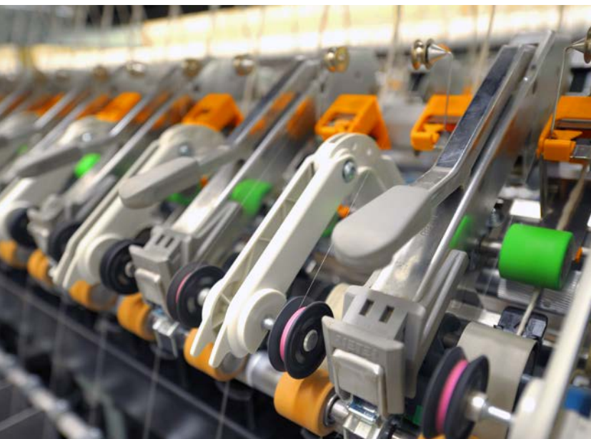
Imagen 2 La mejor solución para todas las aplicaciones: máquina de hilar a anillos Rieter equipada con hilado con alma.
