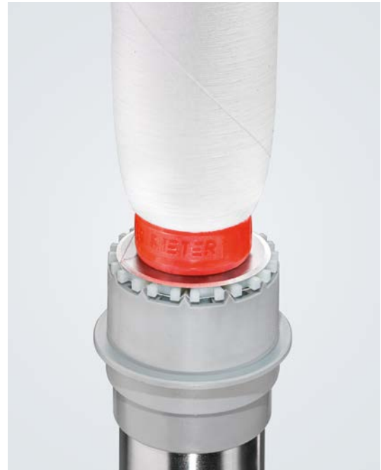
Imagen 1 El cuchillo SERVOfrip separa de forma fiable el hilo en el deslizamiento – especialmente con hilados muy firmes y con hilados core.
