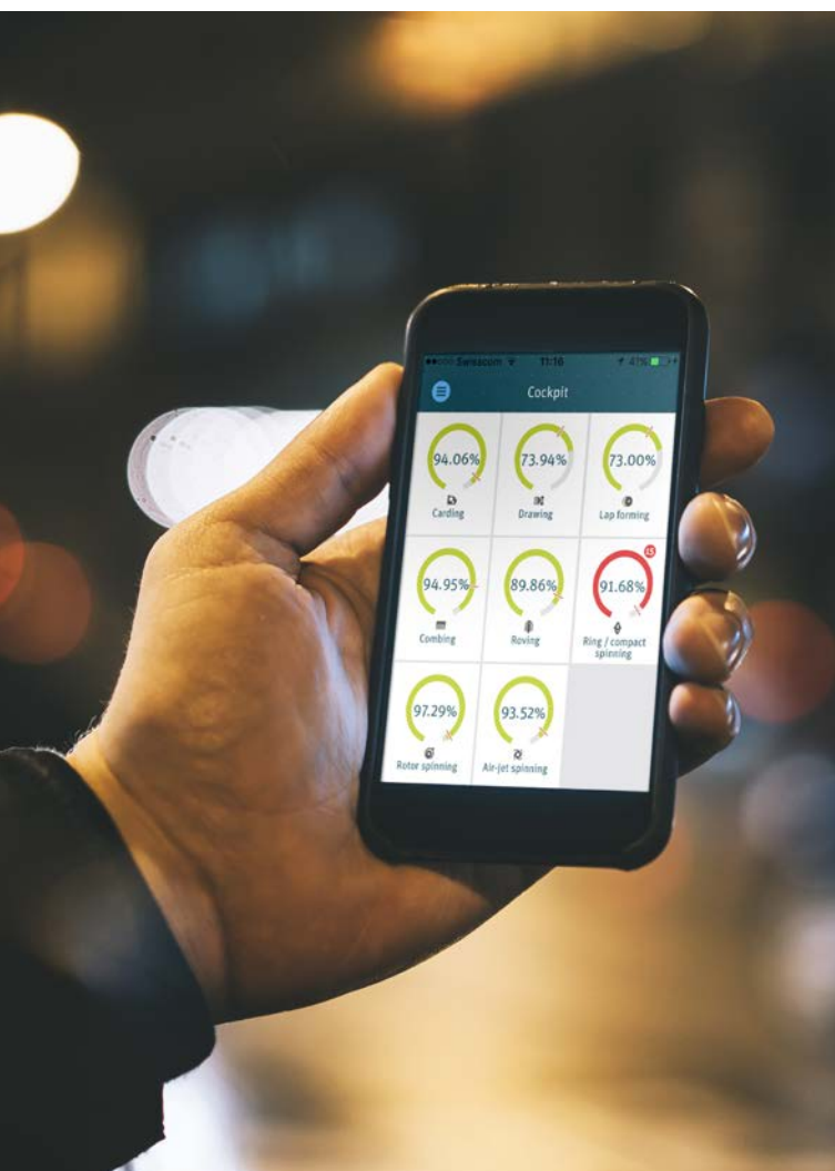
图1：掌控功能可随时随地反映纺纱机的生产状态。这样有利于快速响应，避免停机时间过长而造成重大经济损失。
