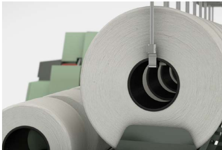
图3：棉卷在运输时全程无接触，质量得以保证。
