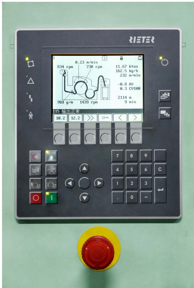
图2：实现产量翻番：梳棉机C 70以160千克/小时的产量运行。
