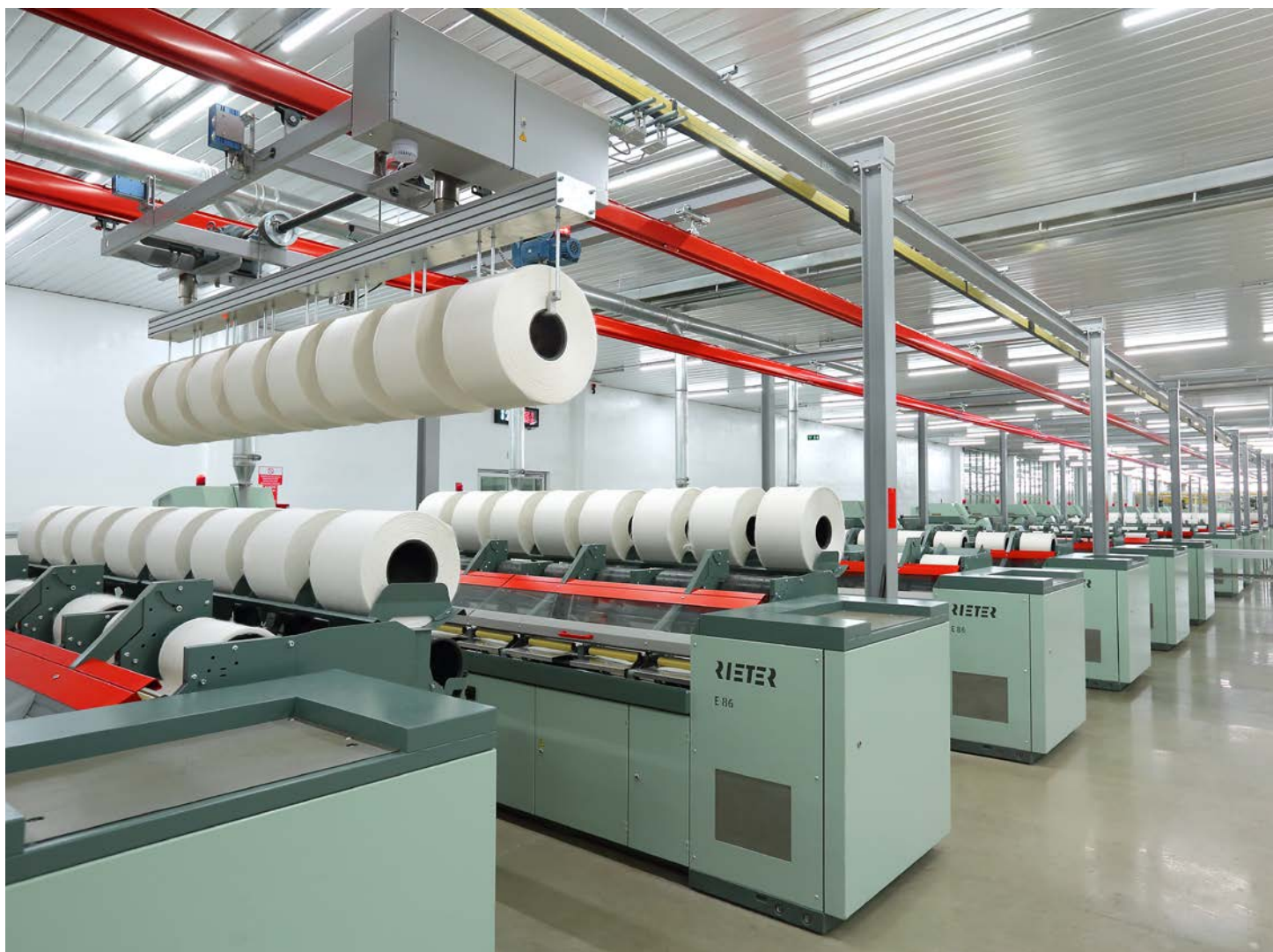
图1：E 26可实现棉卷从条并卷联合机E 36至精梳机的高效运输，同时占地面积小。
