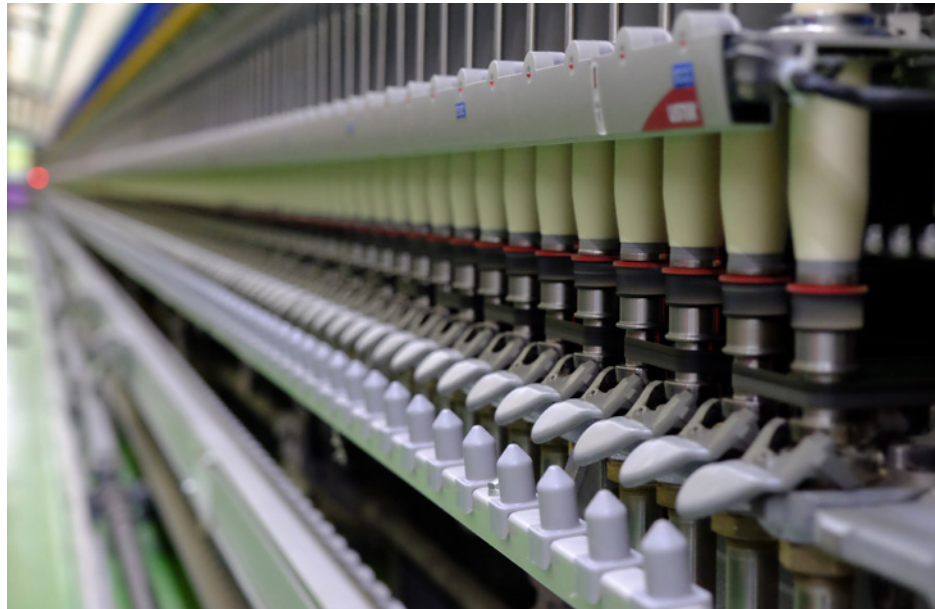
图3：选用NASA HPS 68锭子，客户将受益于其更长的使用寿命、更高的耐用性和降噪性能。
