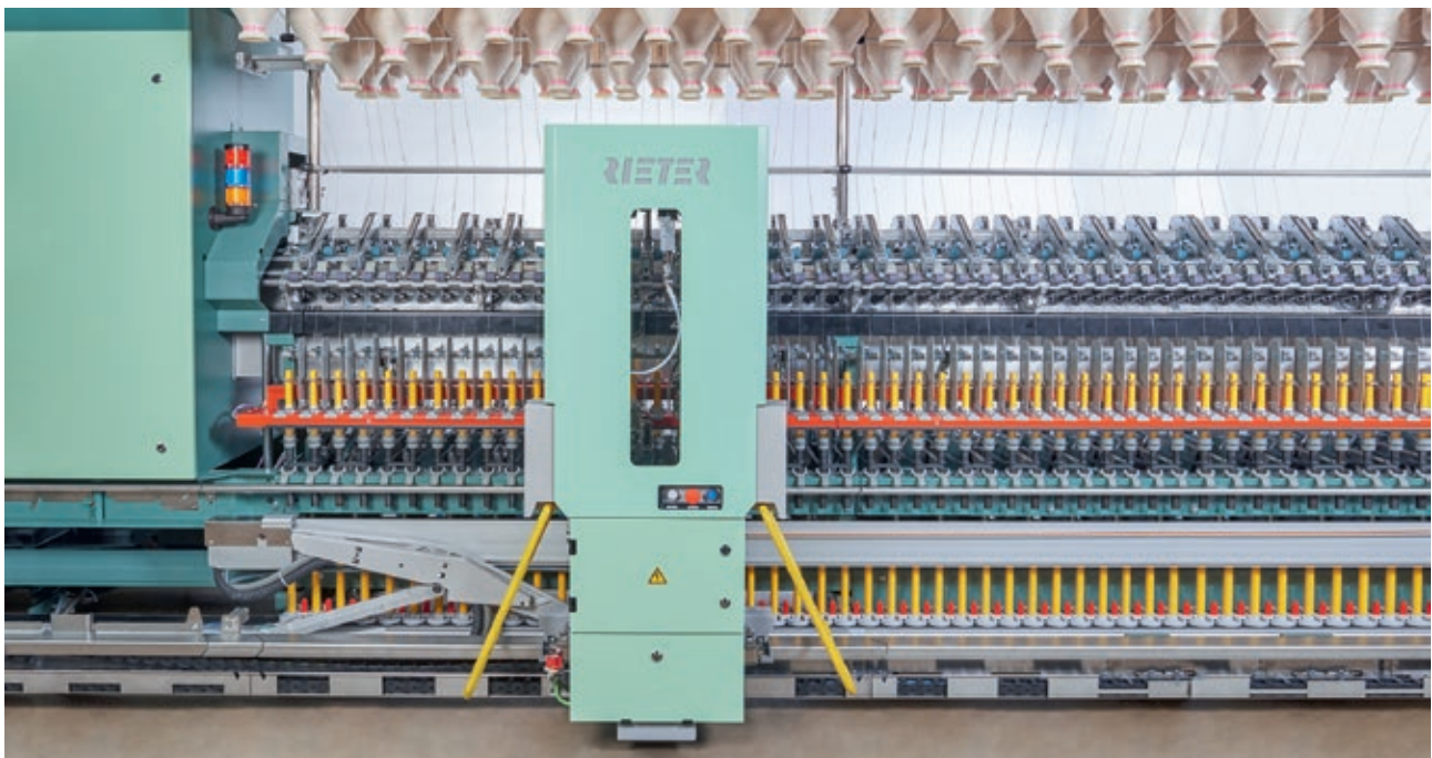
Der Anspinnroboter ROBOspin erhöht die Produktivität und reduziert die Personalkosten.
