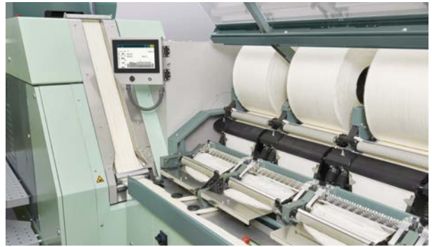
Die Kämmaschine E 90 produziert beste Bandqualität dank der integrierten SB-D 50-Streckentechnologie.
