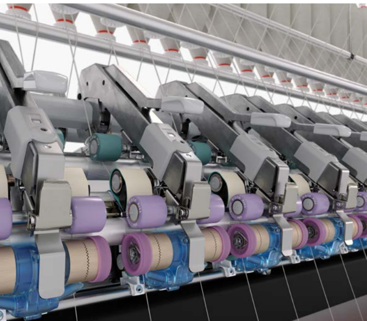
图1：配备全电子牵伸系统驱动和紧密纺装置COMPACTdrum的环锭细纱机G 38，可轻松切换环锭纱和紧密纱生产
