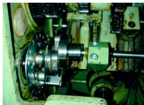
图7: 牵伸传动装置的高度调整
