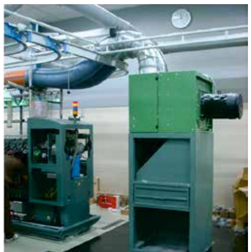
图15: 纱管传送系统的轨道
