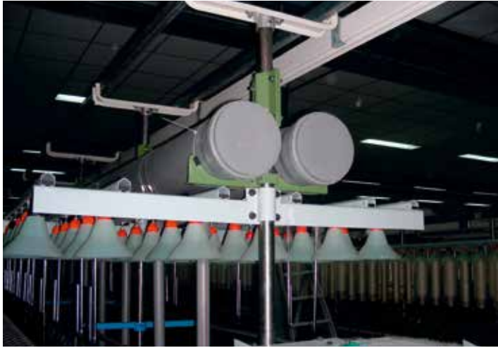
图12: 改变巡回吹吸风装置的位置
