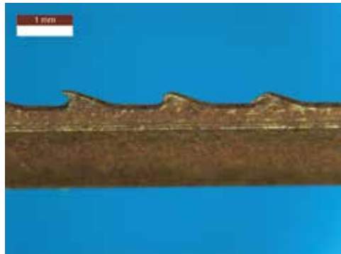
图2和3：接触针布基底造成的针齿损伤
