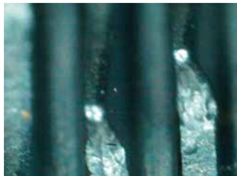
图4和5：齿尖和齿径上明显的碰撞痕迹。
