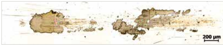
图5: 摩擦测试之后钢领接触区域表面
