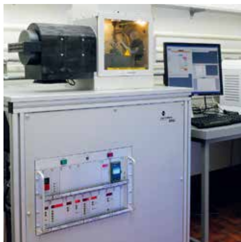
图3：温特图尔IMPE的摩擦仪
