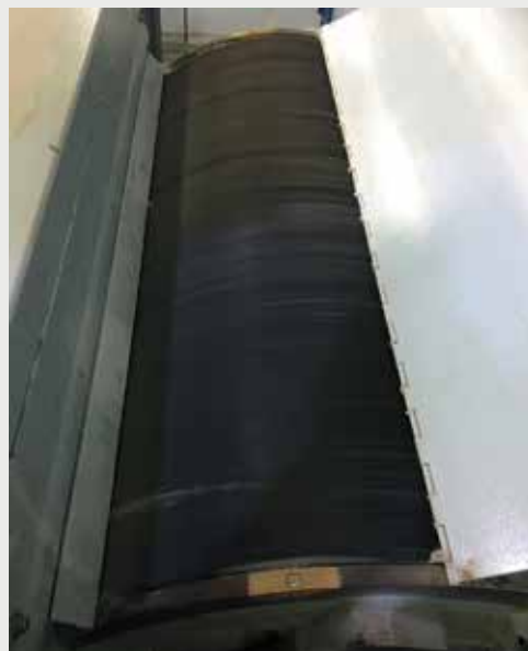
图7：故障成功排除和顺利运行几个星期之后的道夫
