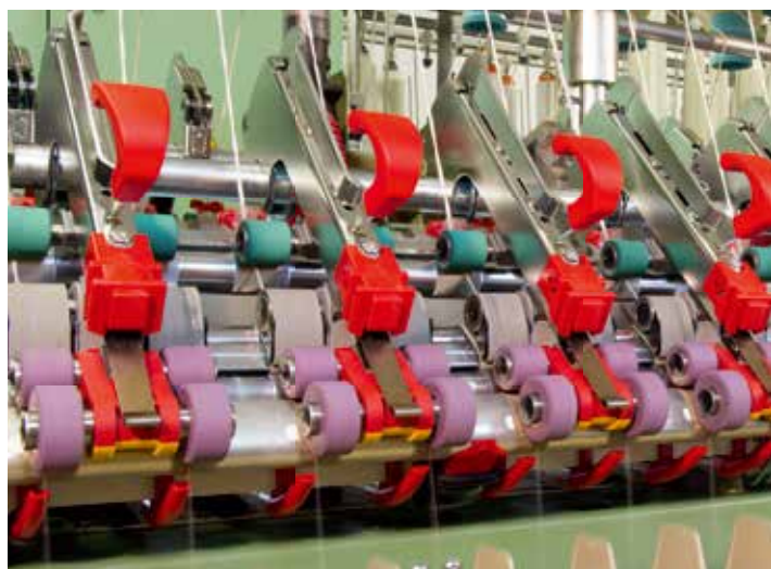
图1: 配备HP-GX 3010 摇架的经典倚丽特紧密纺系统
