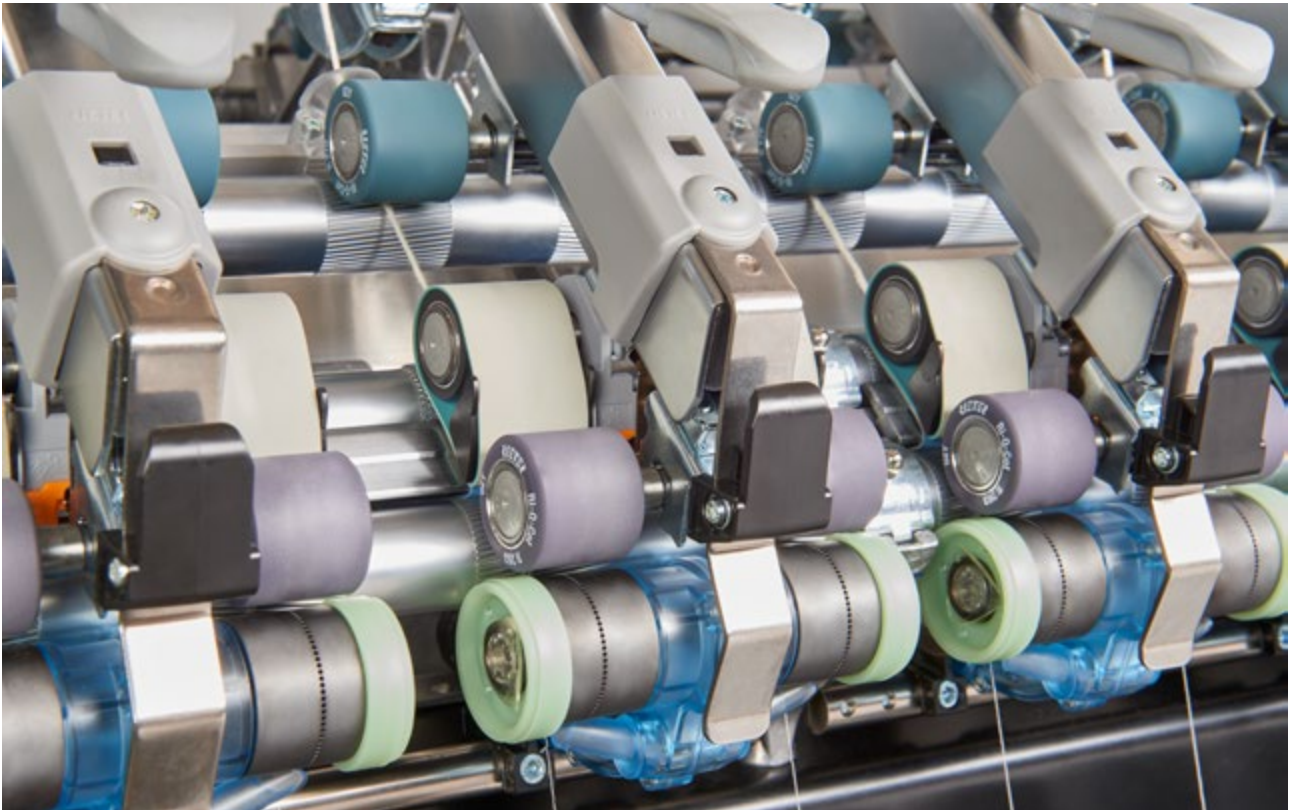
Abb. 15: Effiziente Ressourcennutzung durch die Modernisierung bestehender Ringspinnmaschinen mit COMPACTdrum.
