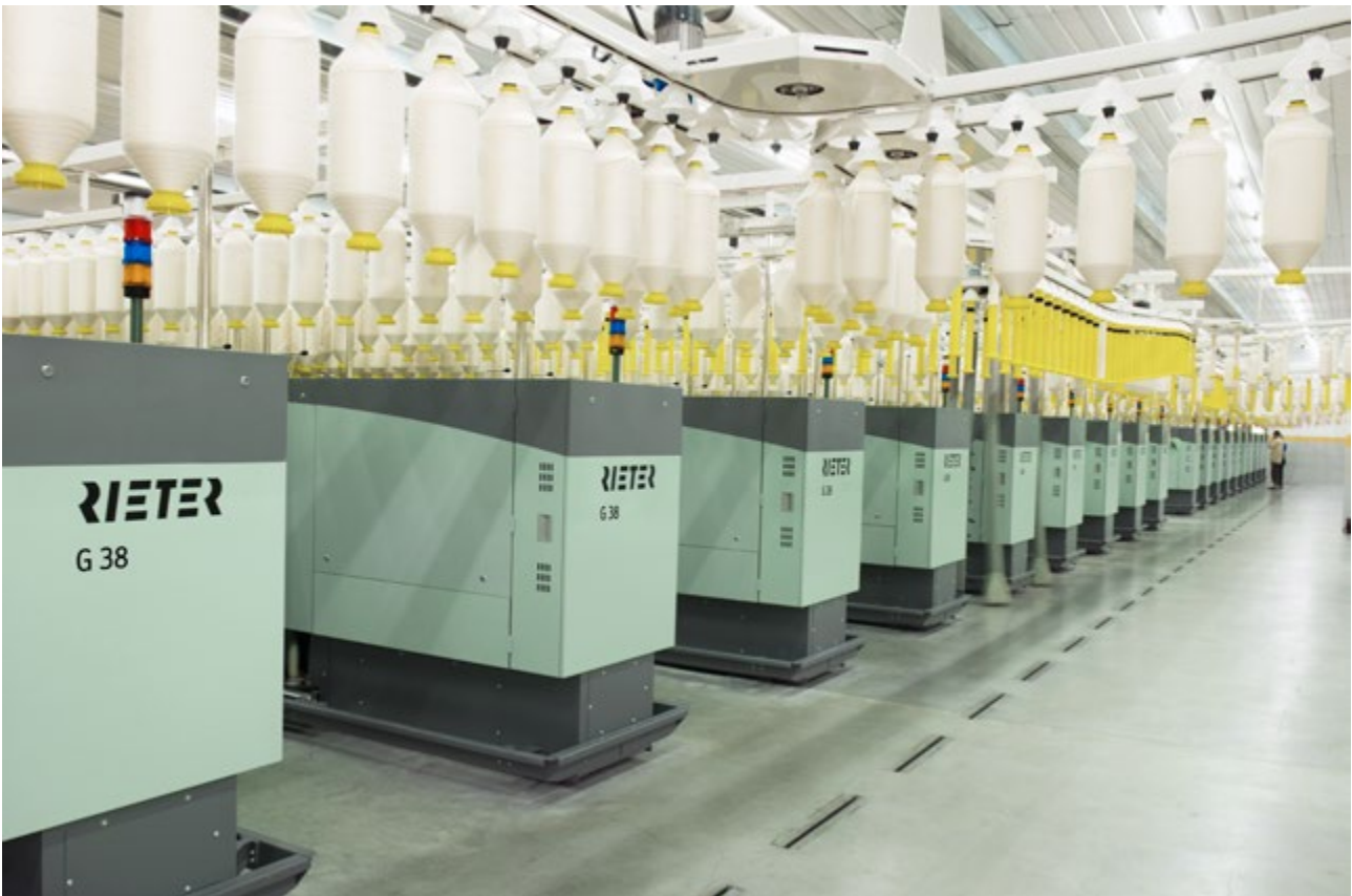
Abb. 11: Die Ringspinnmaschine G 38 nutzt aufgrund der doppelseitigen Absaugung und energieeffizienter Bauteile nur minimale Energiemengen.
