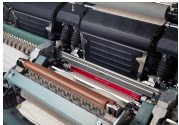
Abb. 6: Die Kämmaschine E 90 garantiert eine behutsame und kontrollierte Handhabung der Fasern, was zu einer optimalen Rohmaterialausnutzung führt.
