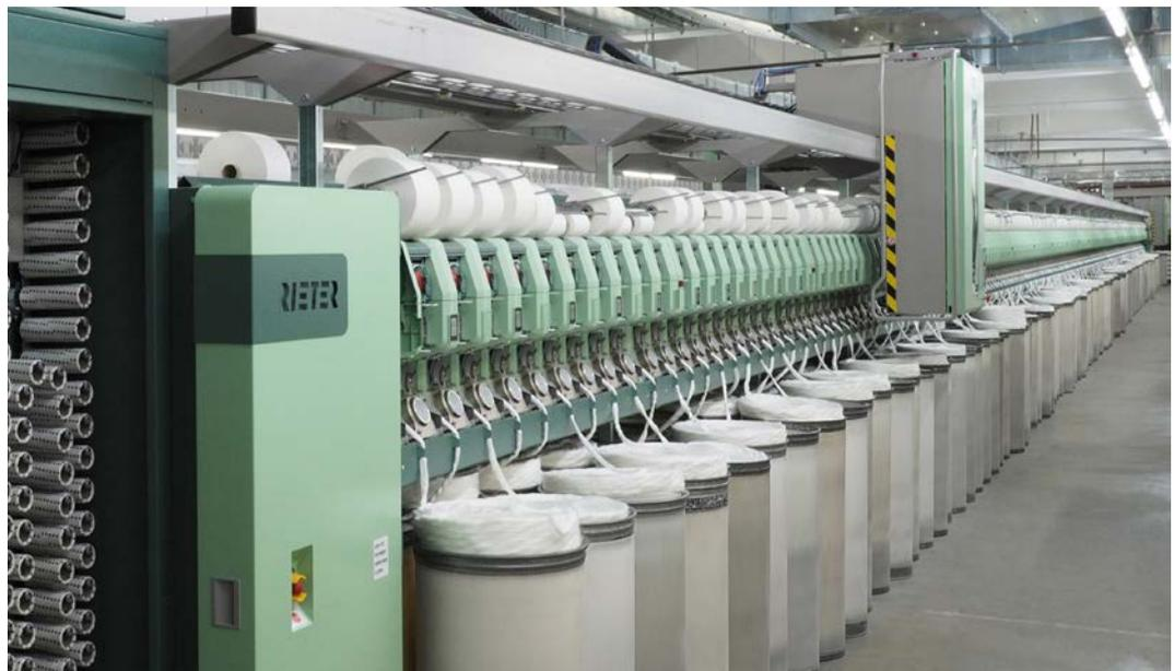
Rotorspinnmaschine R 70
