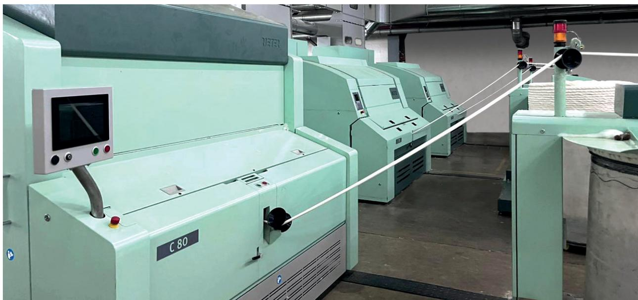
作为埃及的领先环锭纱生产商之一，Skytex Spinning使用高性能梳棉机C 80来提高产能。该梳棉机采用模块化设计，可进一步优化操作、节约成本，从而使Skytex成为行业先锋，为将来的发展做好准备。此外，C 80的投用使公司在能效方面实现了巨大飞跃。
