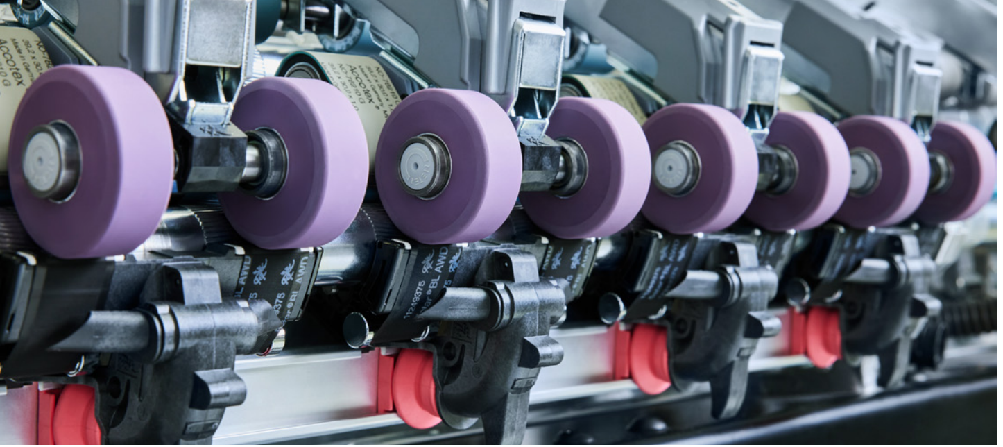
Şek. 1: COMPACTapron, ek 0,5 – 1 cN/tex ile daha yüksek mukavemet değerlerine ulaşır.
