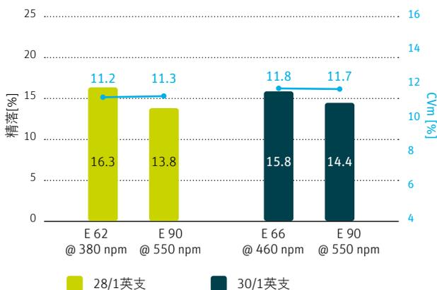
与精梳机E 62和E 66相比，能够保持稳定的CV值和更低的精落水平
