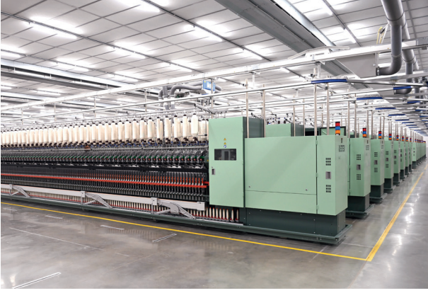
K 47 ve Autoconer X6 doğrudan bağlantısı - Operatörler izleme işlevlerine odaklanabilir.
