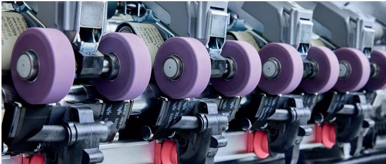
印度Rajaguru Spinning Mills Pvt. Ltd.使用立达紧密纺装置COMPACTapron生产100%粘胶紧密纱。通过将紧密纺装置COMPACTapron集成到21台环锭细纱机G 37中, 实现纱线产能提高7%, 纱线强力增加11%, 纱线毛羽减少25%。
