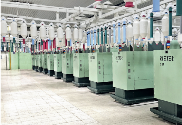
Komplettes Rieter-Ringspinnsystem für hohe Leistung
