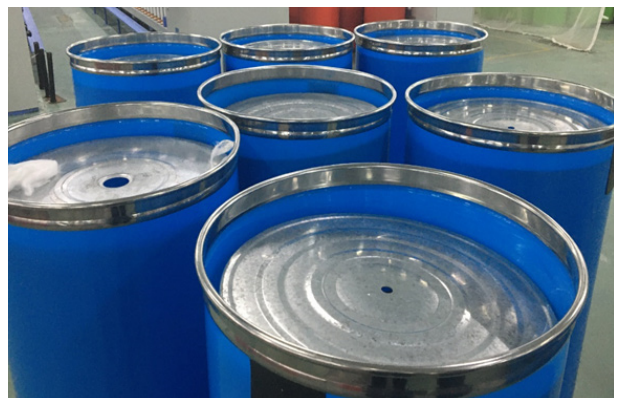
图2: 条筒弹簧老化, 弹簧板位置较低
