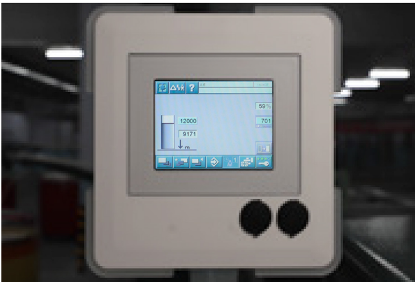
图4：并条机SB-D 50以701 米/分钟的运行速度加工差别化纤维
