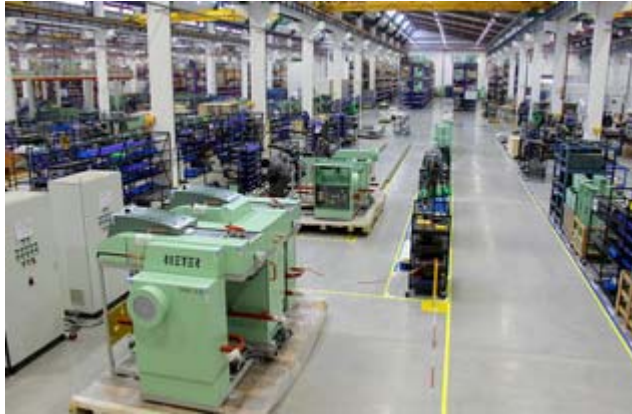
Rieter Changzhou Werk 2 – Montagelinie für Strecken
