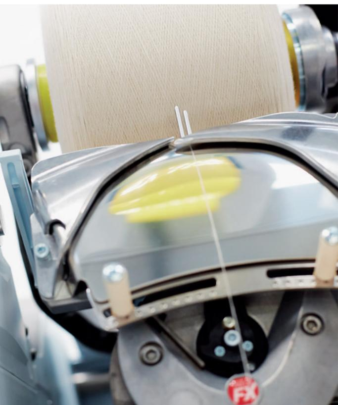
FX是一种软件控制的纱线横动导纱系统，用于将管纱卷绕成筒纱或将筒纱卷绕成新的筒纱。Preci FX允许在三种卷绕技术之间切换：无重叠纱随机卷绕、精密卷绕或分步精密卷绕。
