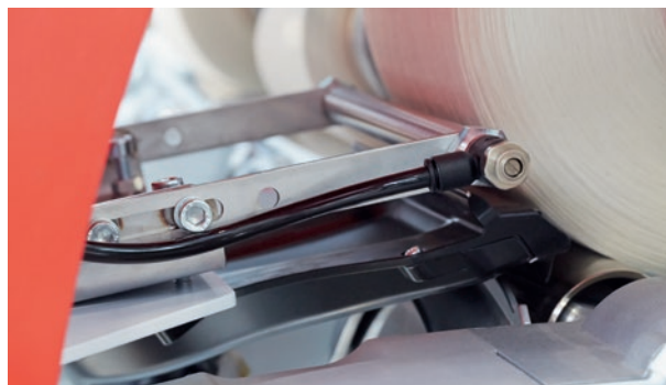
在落纱机上安装Smartjet强力喷嘴可进一步提高上纱头搜寻的成功率。
