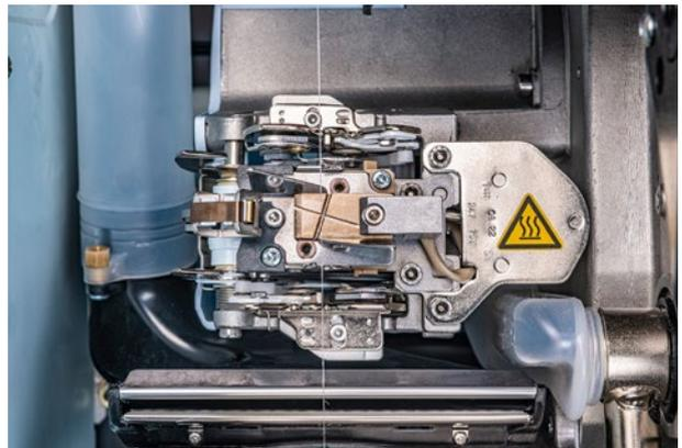
自动络筒机Autoconer X6带有Thermosplicer热捻接器
