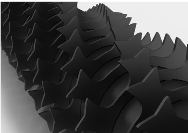
打手螺旋状分布可使纤维获得最佳开松，另外可以减小振动。
