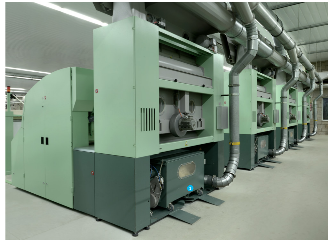
刺辊单独排杂装置 ① 连接至除尘室。
