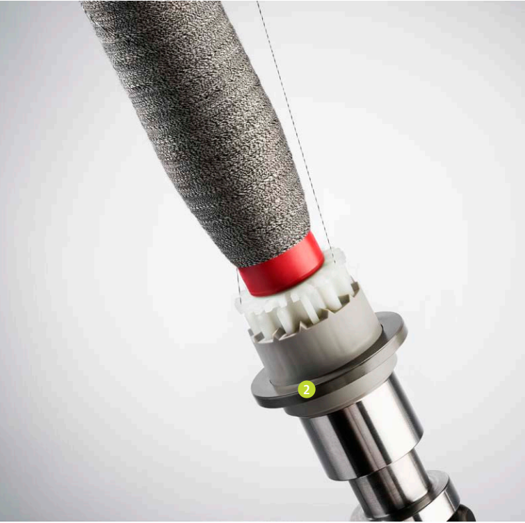
SERVOfrip: değiştirilebilir, alt sarımsız özgün takım çıkarma, Rieter ring iplik ve kompakt iplikçilik makineleri için
