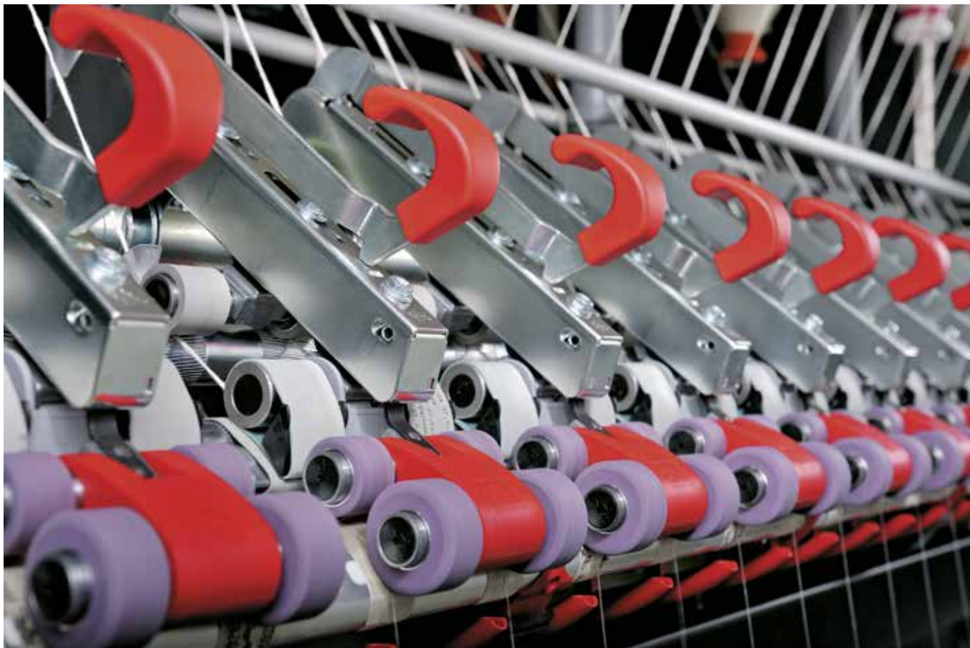
El brazo de presión HP-GX 3010-E para la hilatura compacta con el sistema de hilar Elite®CompactSet
