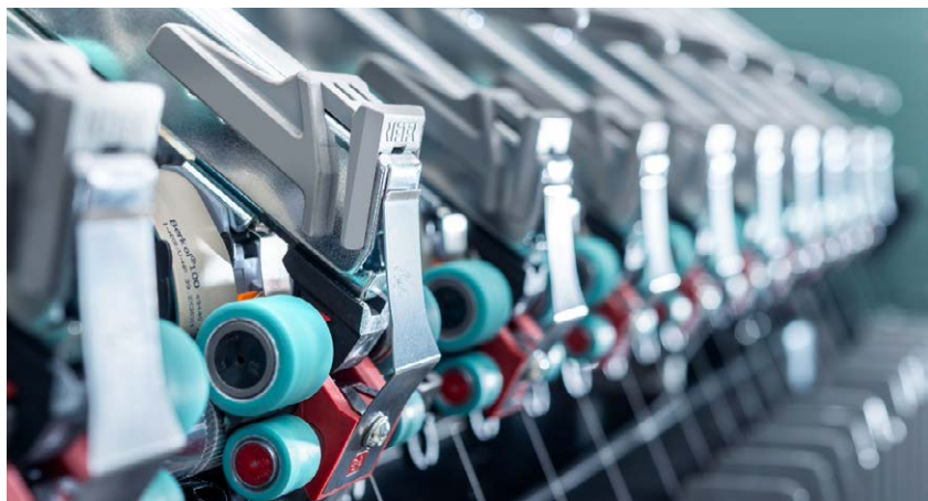
COMPACTeasy em um braço de pesagem superior Rieter P3-1
