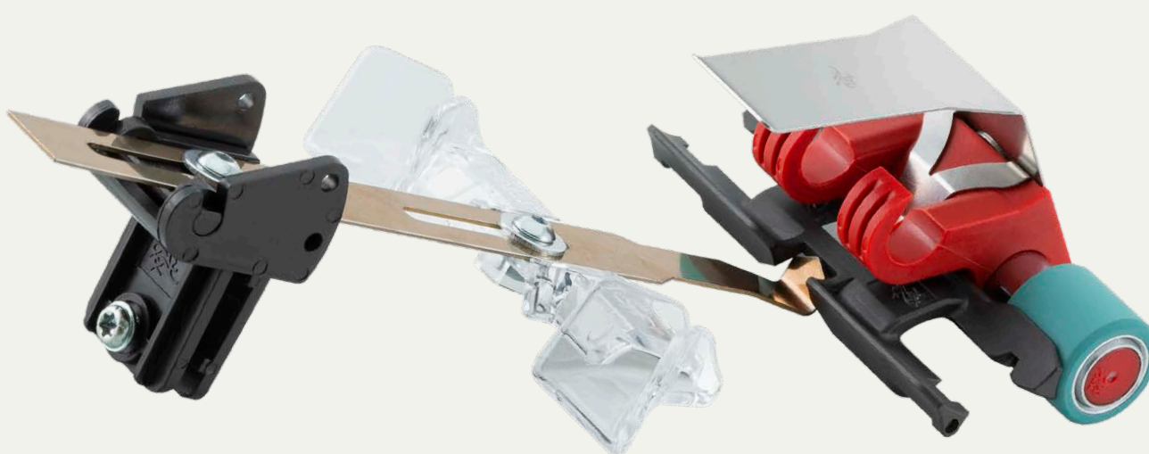
Transmissão do movimento transversal para o compactador (vista de trás)
