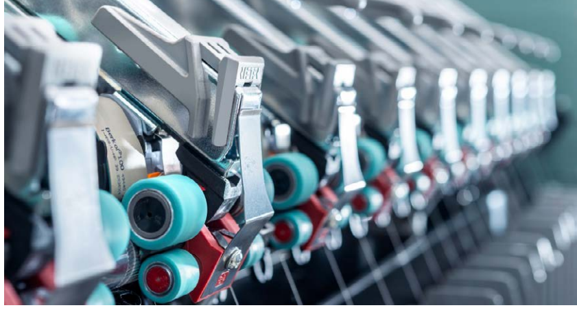
Rieter P3-1 baskı tabancasındaki COMPACTeasy
