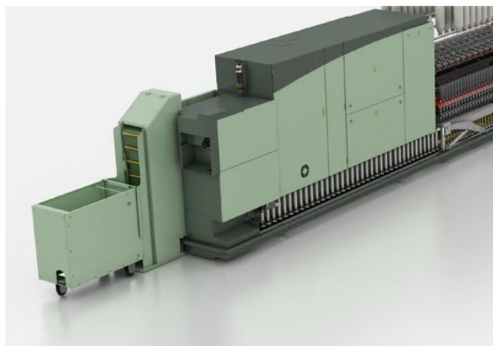
WILDload系统：纱管被逐个拣出，经过对齐后喂入纱管装载装置ROBOload中。
