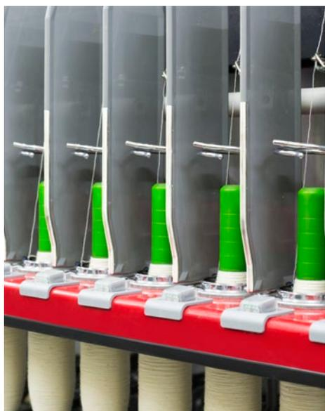
立达提供全套专业部件，尤其适用于化纤，由SERVOgrip切刀、大直径下罗拉和加强型隔纱板等组成。它采用模块化设置。各元件可根据客户要求进行配置。化纤套件可改善化纤和混纺的纺纱性能。
