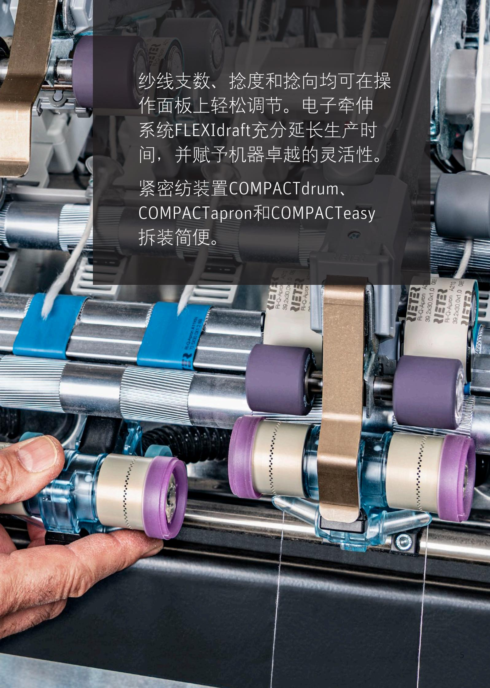
纱线支数、捻度和捻向均可在操作面板上轻松调节。电子牵伸系统FLEXIdraft充分延长生产时间，并赋予机器卓越的灵活性。紧密纺装置COMPACTdrum、COMPACTapron和COMPACTeasy拆装简便。
