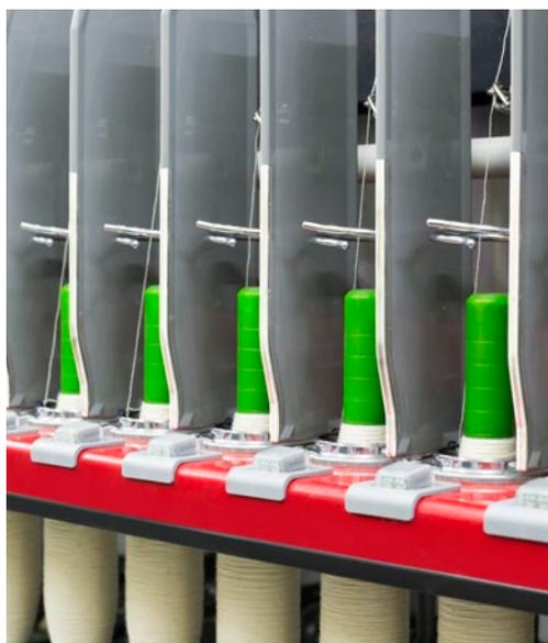
立达提供全套专业部件，尤其适用于化纤，由SERVOgrip切刀、大直径下罗拉和加强型隔纱板等组成。它采用模块化设置。各元件可根据客户要求进行配置。化纤套件可改善化纤和混纺的纺纱性能。
