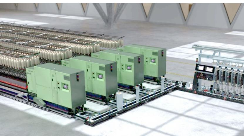
使用多联式细络联Multilink系统联接连接到络筒机
