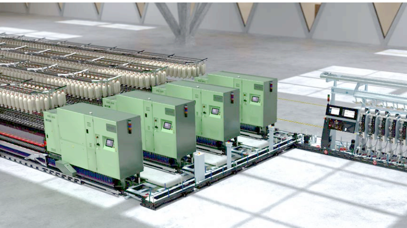
Multilink sistemiyle bobin makinasına bağlantı
