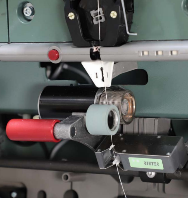
Tek tahrikli AMİspin-Pro (yukarıdaki) veya AMİspin'in aktarma mili ile çıkış (sağda)
