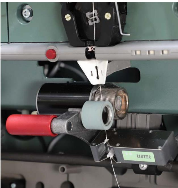
Salida con mando individual de AMIspin-Pro (arriba) o con árbol de rodillo de salida de AMIspin (derecha)
