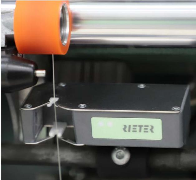
O R 37 pode ser equipado opcionalmente com o Q 10, a nova geração de limpadores de fio da Rieter. As principais vantagens do sistema digital de limpeza de fios comprovado em fábrica com sistema de imagem óptica são:
