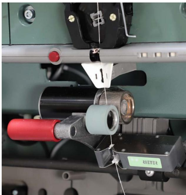
Saída com acionamento individual da AMIspin-Pro (em cima) ou com eixo de saída da AMIspin (à direita)
