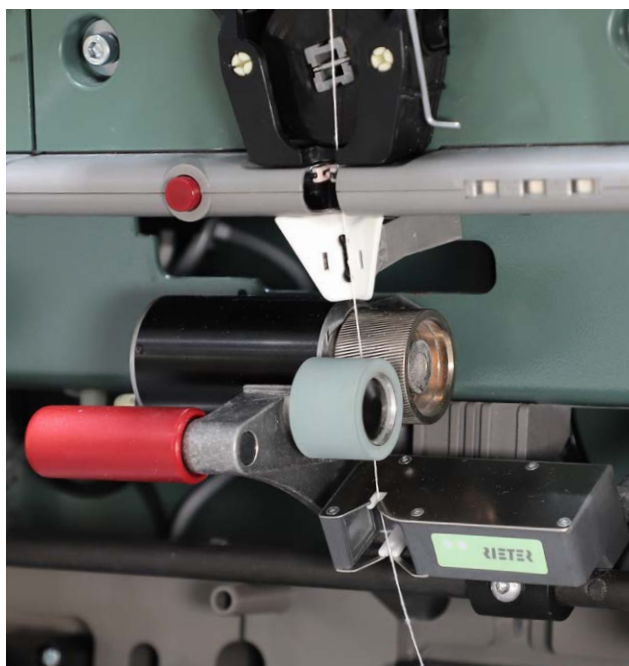
Подача с помощью одного привода AMIspin-Pro (выше) или выпускного вала AMIspin (справа)
