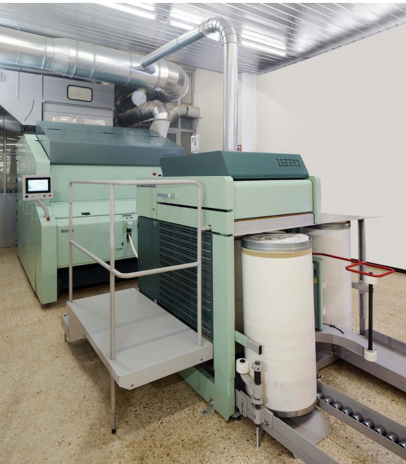
自调匀整并条模块RSB-Module 55与梳棉机直联。基于久经应用验证的自调匀整并条机RSB-D 55驱动和牵伸技术。还拥有自调匀整和出条监测环节全新的检测技术。确保更好的棉条和纱线质量。
