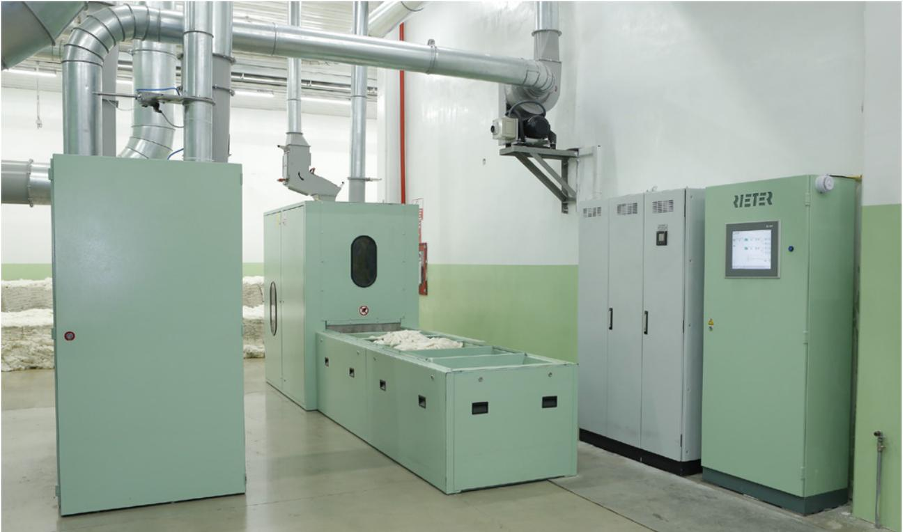
Alimentación retrógrada medida de desperdicios desde el sistema de apertura/limpieza y carda
