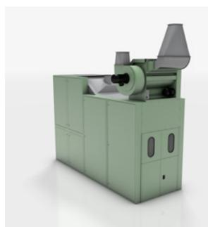
Abridor de mezclas B 33 para mezcla, limpieza y apertura
