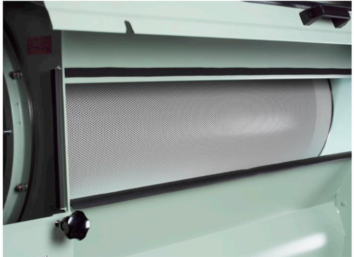
Transporte óptimo de copos y desempolvado máximo con el condensador A 21
