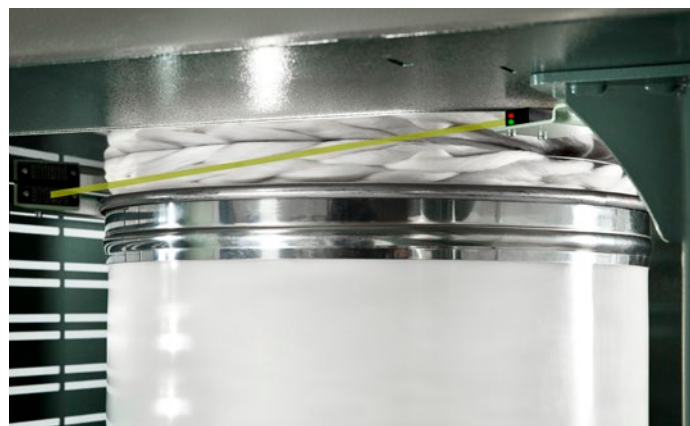
Fotocélula para o enrolamento controlado da fita da carda
