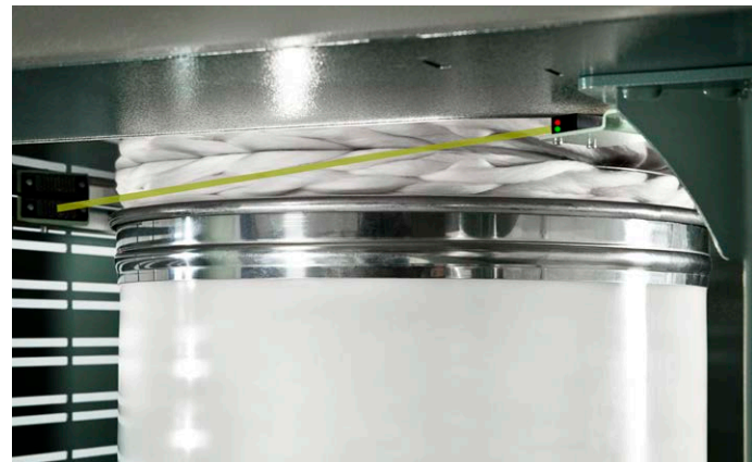
Barrera de luz para bobinado controlado de la cinta
