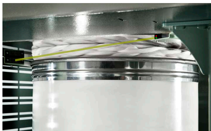
Fotocélula para o enrolamento controlado da fita
