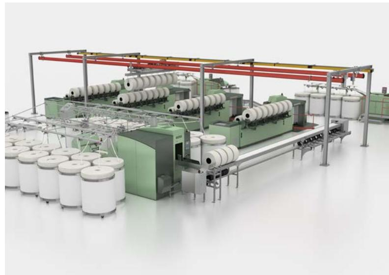
Oito rolos são transportados simultaneamente usando o sistema de transporte totalmente automático SERVOLap E 26.
