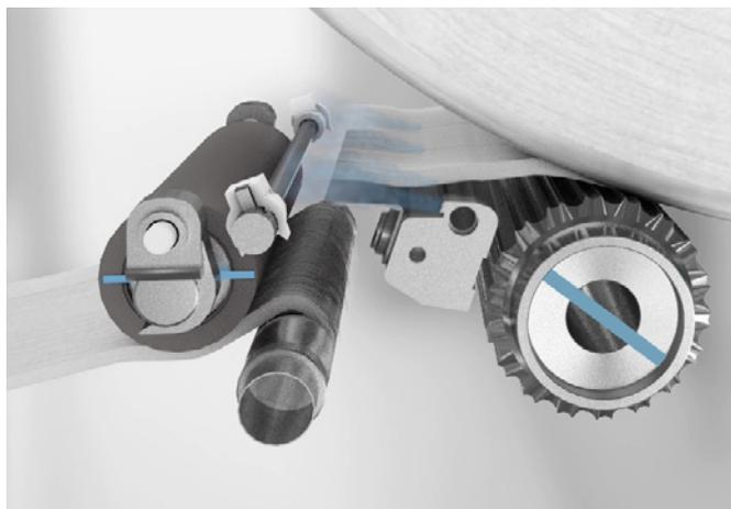
O sistema de troca de rolo e emenda da manta ROBOLap
