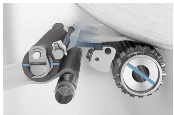
Sistema automático de cambio de rollos y empalme de napas ROBOLap
