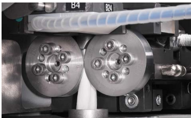
Rieter Quality Monitor (RQM) para verificações consistentes da finura da fita de saída
